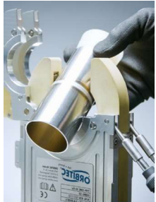
Rohrleitungsbau mit WIG orbital Schweißung
